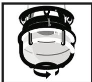
**IMPORTANT:** Avant d'enlever l'ampoule du four ou la tentative de changement il faut couper l'alimentation électrique du four.
